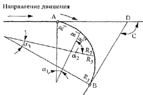
Рис. 8.3. Схема для расчета коробовой кривой
